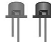
Le courant nominal d'une LED est de l'ordre de 10 à 50 mA, pour les LED usuelles, suivant la couleur de la radiation
